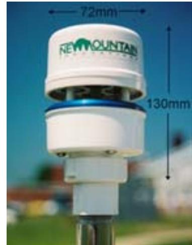
GPS を搭載し、風向・風速・気温・湿度・気圧・移動方向・速度を計測する小型軽量センサー（重量 285g）
