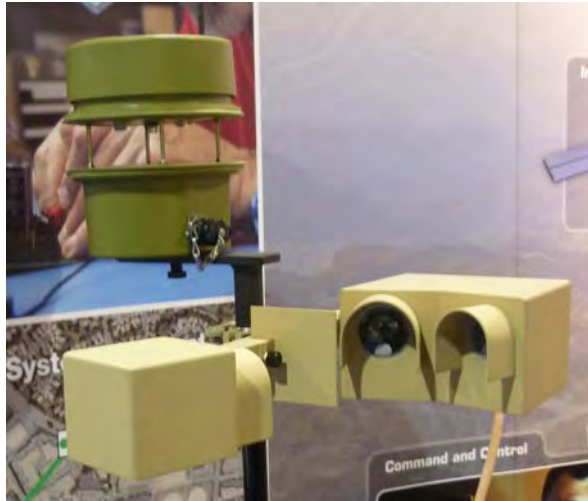
視程センサー (右) と 風速・温度・湿度・雨量センサー (左上)
