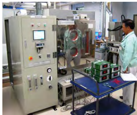
新装置を用いた湿度計検定の様子
