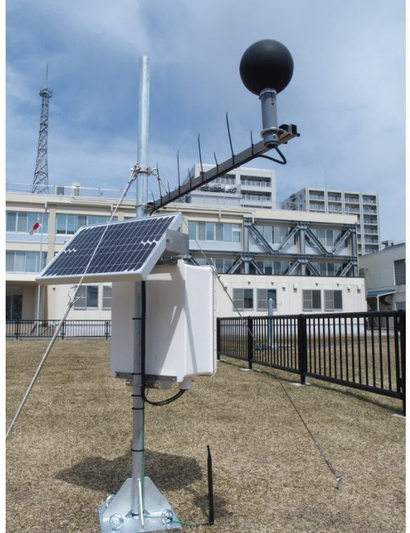
札幌に設置された湿球黒球温度観測機器
