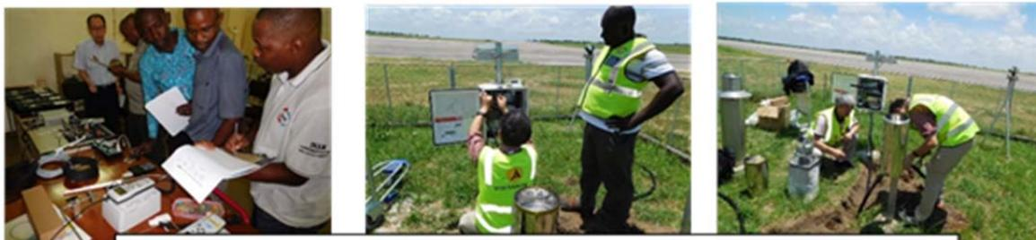
気温・湿度センサーの校正、現地での設置風景。円筒が前回設置した雨量計
