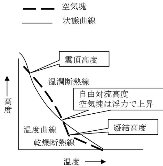
図7 凝結高度、自由対流高度の概念図
