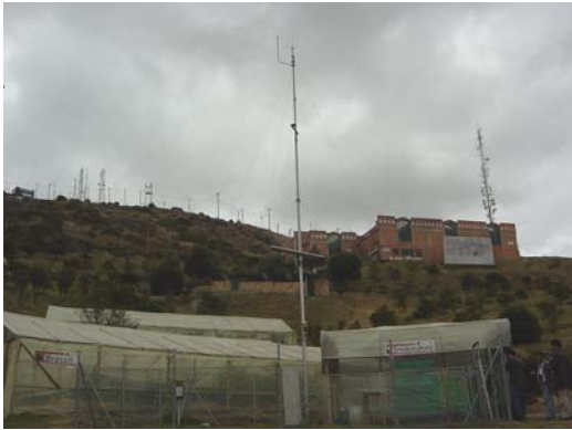
気象衛星のデータ収集機能を使った自動気象観測所
