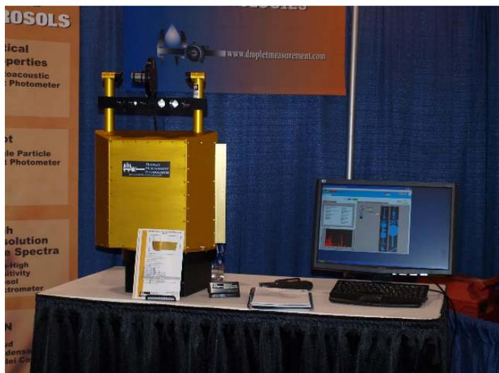
(Meteorological Particle Spectrometer) が展示されており、レーザー光源(写真 筐体から上に伸びた左側の部分)と64個のディテクター(写真 光源部に相対した右側の部分)を用いて、50 $\mu$ 以上の雨粒・霧粒の粒子の直径と形状を観測・判定し、空港等での霧雨の観測に用いられているとのこと。雲粒観測では、ろ紙に捕獲した雲粒の人手によるカウントや飛行機からビデオ観測で雲粒を観測する手法を文献で読んだ記憶がありますが、今は忘れ去られているレトロな観測分野にも、新しい技術の適用分野がまだまだあるのではないかとの感想を持ちました。この機械は、日本にも既に2台導入され研究に活用されているとのことでした。
