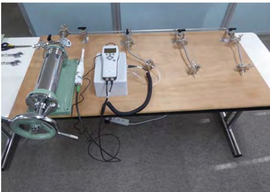
左： 組み立て終わった気圧計校正装置 (手動ポンプ、パイプレイアウト、供与予定気圧計準器)
