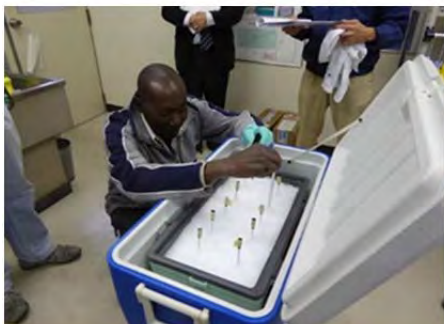
上3枚：研修生による氷点を用いたの温度計検査
