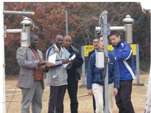
上：アスマン（通風式乾湿計）とAWS（総合気象観測システム）センサー比較
