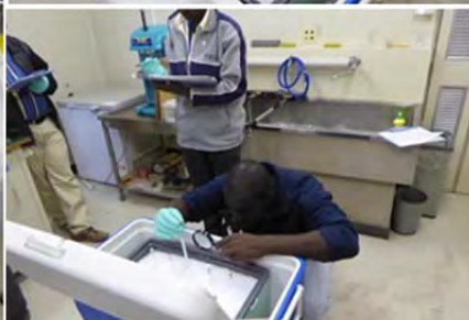
上3枚：研修生による氷点を用いたの温度計検査
