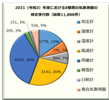
図4 2021 (令和3) 年度の受付数 11,888 件の8種類の気象測器別の受付数と割合 (%)。
