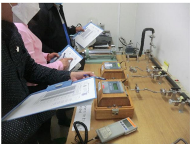
実習「気圧計校正」 気象測器検定試験センター
